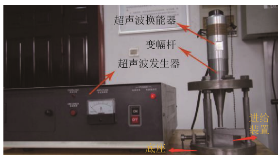
图 8 实验用超声振动粉碎装置图
