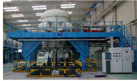
图 2 氢气气氛中频烧结炉 ( \phi 1650 \text{ mm} \times 2500 \text{ mm} )
