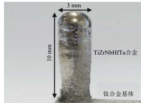
图3 激光熔化沉积成形 \text{TiZrNbHfTa} 高熵合金圆柱体 [25]
