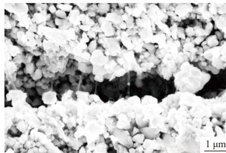
图5 脱脂温度不合理引起脱脂裂纹
