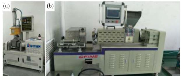
图 2 密炼机 (a) 和造粒机 (b)
