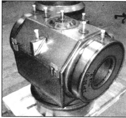
图 7 带装料与除气管的包套结构例 [1]
