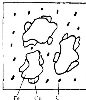
图2 铜作为Distalloy Cu添加的Fe—Cu—C混合料
